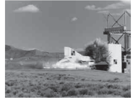
Fotografía 13.4 Con esta prueba de impacto entre un F-4 Phantom y un objetivo rígido reforzado se determinó la fuerza del impacto en función del tiempo. ©Sandia National Laboratories/ Getty Images
