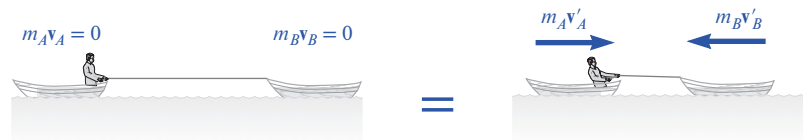
Figura 13.18 Al ignorar la resistencia del agua, se conserva la cantidad de movimiento lineal para dos botes que se jalen entre sí.
