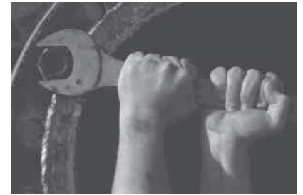
Fotografía 3.2 La fuerza ejercida por cada mano sobre la llave puede reemplazarse por un sistema equivalente fuerza-par que actúa sobre la tuerca. ©Steve Hix
