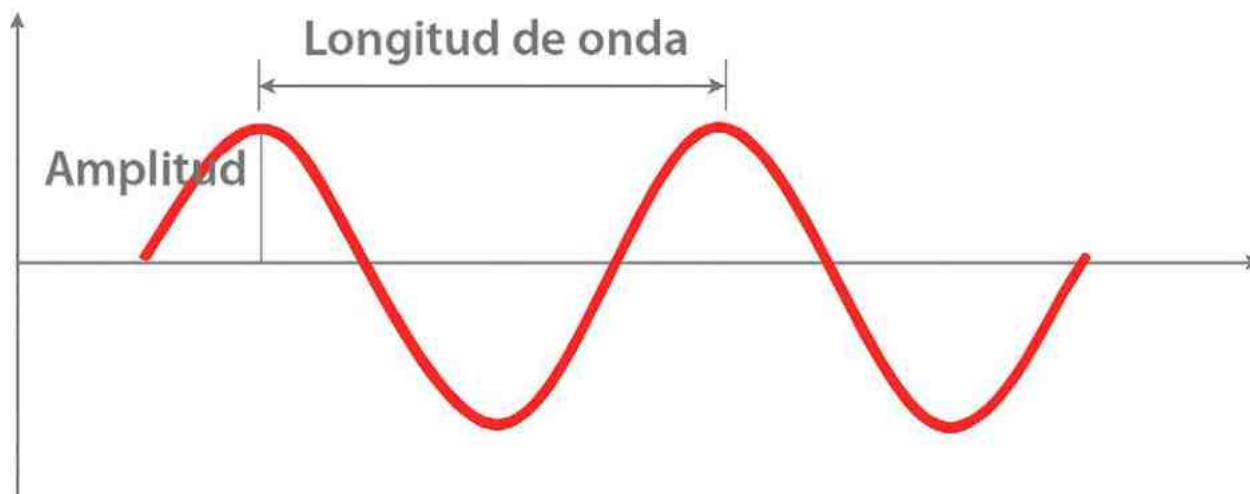
Figura 2.1. Representación de las ondas electromagnéticas en la que se aprecian dos magnitudes importantes: la amplitud y la longitud de onda.
