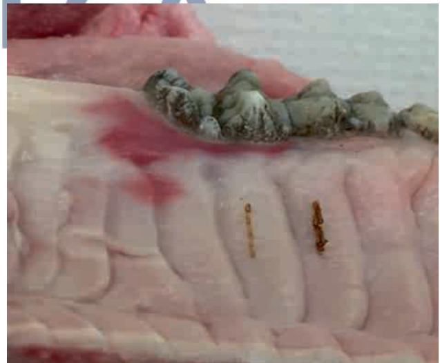
Figura 2.10. Se utilizó un láser de diodo de 810 nm con una fibra de contacto de 400 μm a 1,0 W de onda continua para ambas incisiones en una muestra de maxilar porcino. La incisión izquierda se hizo con un movimiento vertical más rápido que la incisión derecha. La incisión izquierda es más estrecha; la derecha es más ancha, más irregular y produce una temperatura más elevada en el tejido. Por lo tanto, la densidad de potencia fue mayor en esa incisión.
