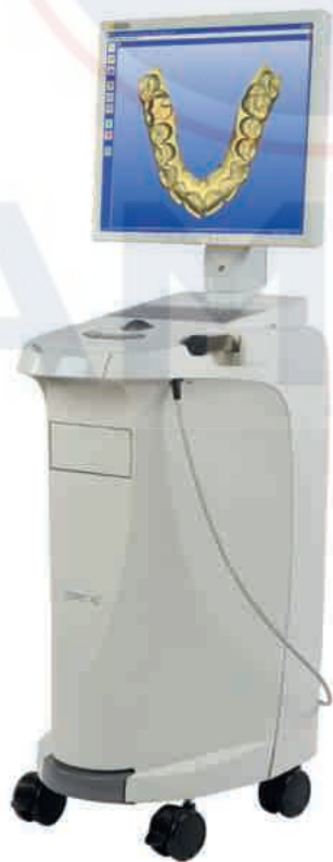
Figura 10.6. Sistema de diseño asistido por computadora para la fabricación de restauraciones totalmente cerámicas (Cortesía de Sirona Dental Systems, LLC, Charlotte, Carolina del Norte).
